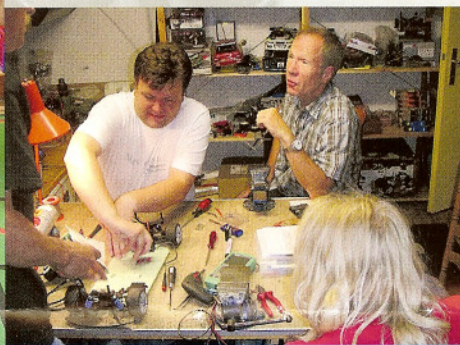
Die Tüftler am Werk: Achsen, Lenkservo und Brennstoffzelle werden an das Eigenbau-Chassis angepasst
